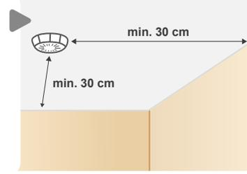
Dans les pièces où le plafond est incliné, les détecteurs doivent être installés sur un mur en respectant ces distances :
