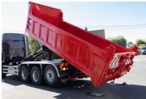
Positionnez les protections sous les roues du conteneur, lors du déchargement du conteneur
